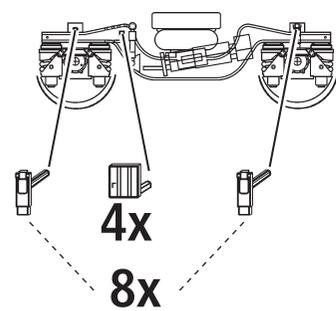
**Gehäuseabnahme / Remove body / Démontage de la caisse:**
